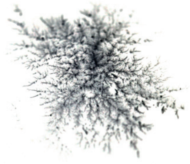
Kavitationsabbild in Sternstruktur (vergrößerte Darstellung).
